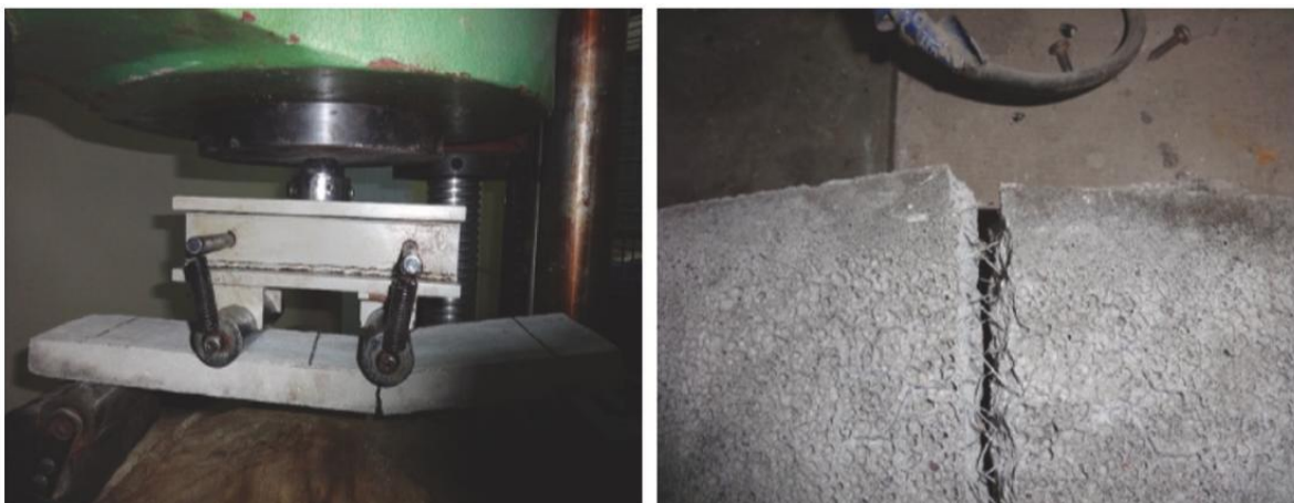
Сурет 3. Полимер негізіндегі иілу панельдері
