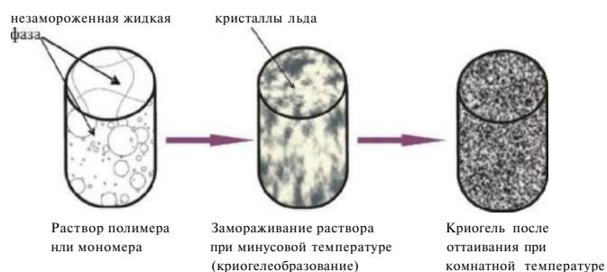
Рисунок 1 - Схематическое изображение процесса синтеза макропористого криогеля
