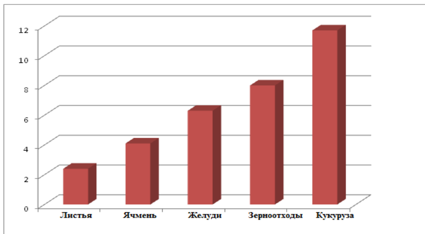
Рисунок 6. Извлечение золота из хвостов в присутствии биодобавок
