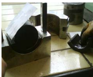
Сурет 3. Суға тұрақтылығын анықтауға арналған су құйылған ыдыс 15 күннен кейін судан алып, 3 тонналық күші бар құралда сығамыз.
