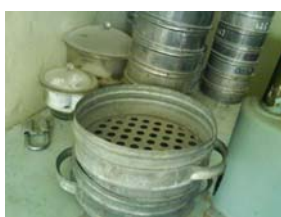
Сурет 2. а) фракциялауға арналған құрал; ә),б) фракцияланған тастар в) пайдаланылған құм
