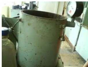
Сурет 3. Суға тұрақтылығын анықтауға арналған су құйылған ыдыс 15 күннен кейін судан алып, 3 тонналық күші бар құралда сығамыз.
