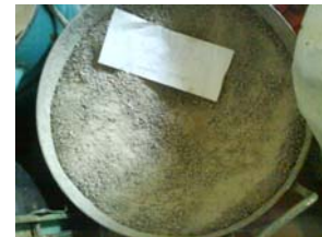
Сурет 2. а) фракциялауға арналған құрал; ә),б) фракцияланған тастар в) пайдаланылған құм
