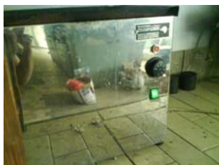
Сурет 3. Суға тұрақтылығын анықтауға арналған су құйылған ыдыс 15 күннен кейін судан алып, 3 тонналық күші бар құралда сығамыз.
